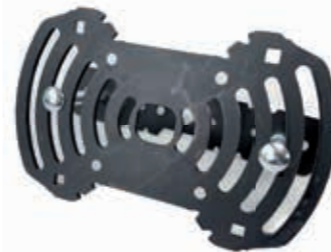
171100 APPKF-Anbauplatte Multifunktionale Anbauplatte für die Halter der Serie P, K und F an plane Fläche und Profile mit maximal 205mm Breite. Für Schraubenmaterial M8. Grau pulverbeschichtet, inkl. Schraubenset
