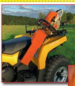
Tine spezielle Motorsägenhalterung Cfür ATVs und Quads hat Christoph Cepak aus Weitra im niederösterreichischen Waldviertel entwikkelt; ursprünglich war sie für den Arbeitnehmerschutz gedacht, da Verletzungen und Unfälle beim Handling mit Motorsägen sehr häufig sind. "Dies besonders beim Einsatz auf Arbeitsbühnen und bei engen Platzverhältnissen", weiß Christoph. "Hier gab es bislang keine zufriedenstellende
